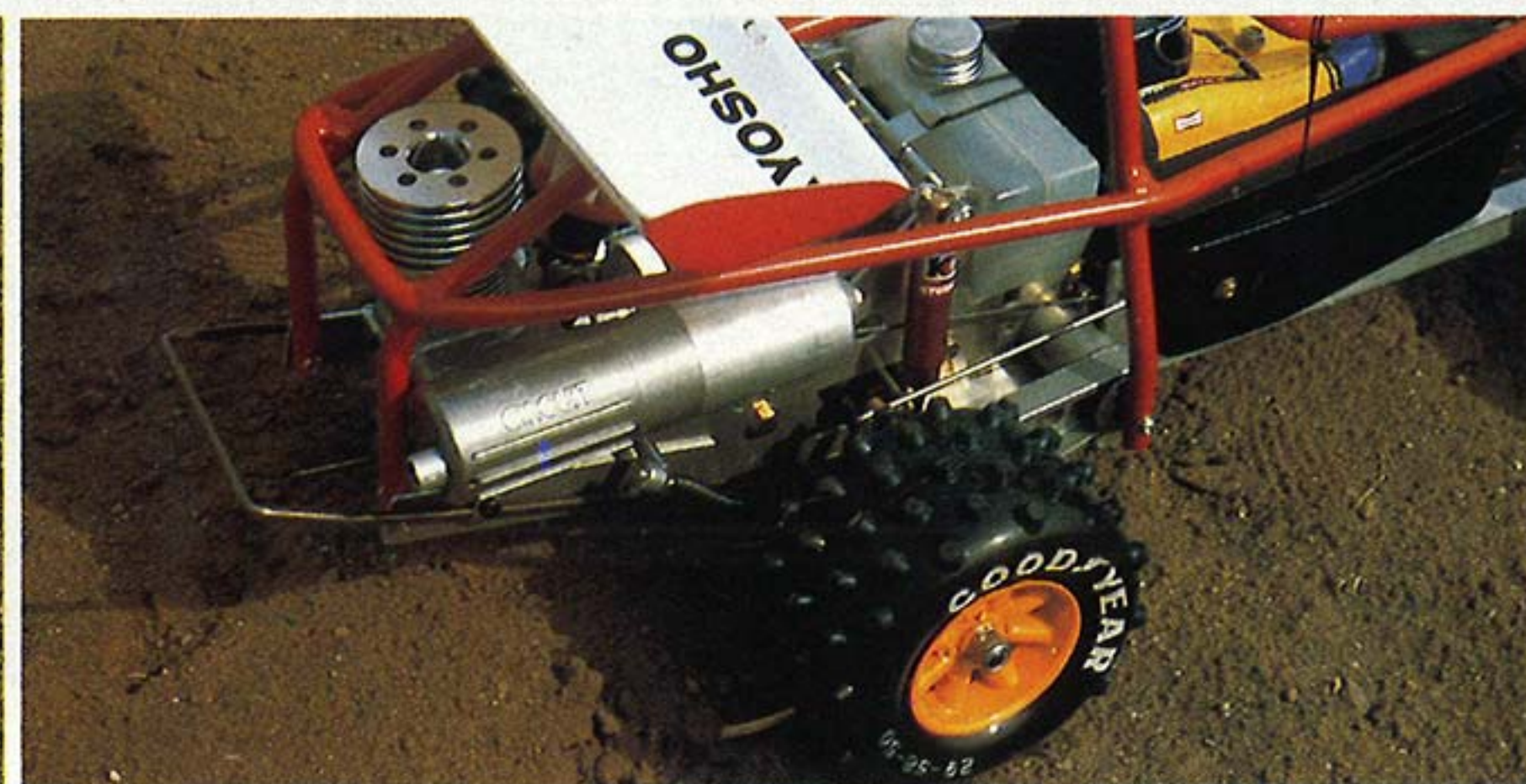
リヤサス・スプリング支持を最良の位置にセットアップでき、路面に合わせたセッティングが簡単にできます。
