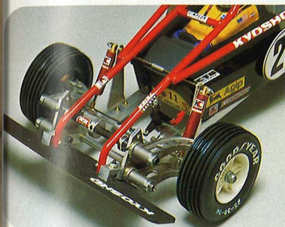
フロントは、荒地走行にすぐれたダブル・トレーリングアームに新型バンパーを装備。
